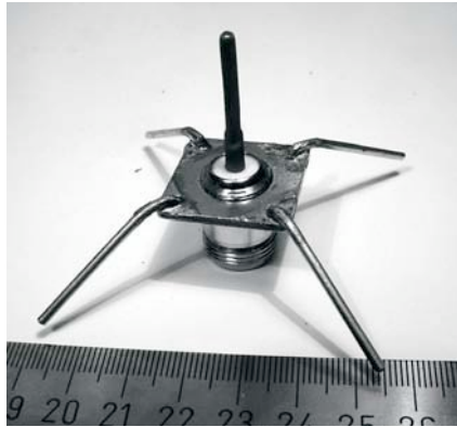
Figure 4.8: Antenne ground-plane d'un quart de longueur d'onde.
