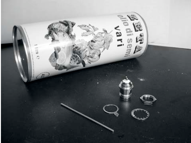
Figure 4.34: Composantes requises pour une cantenna.
