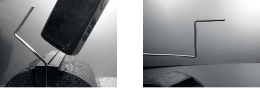
Figure 4.17: Plier le fil en forme de « Z ».
