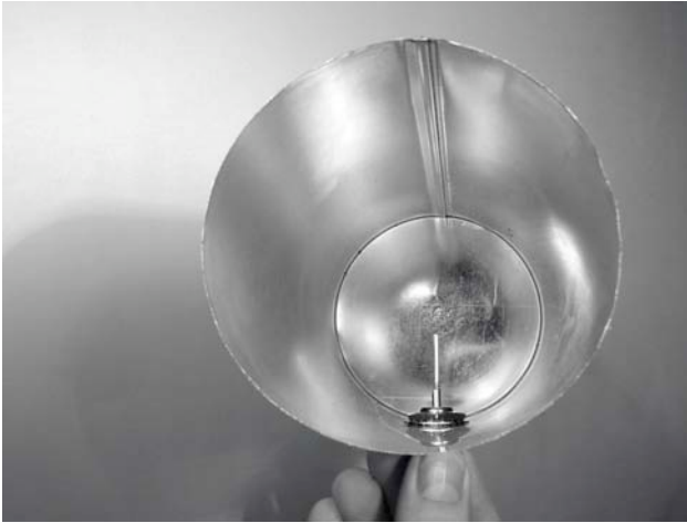
Figure 4.42: Votre cantenna terminée.
