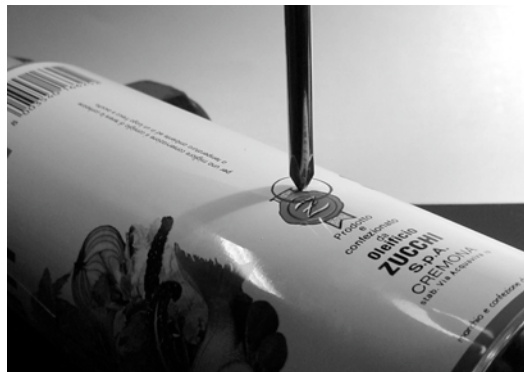
Figure 4.36: Marquez le trou avant de percer.
