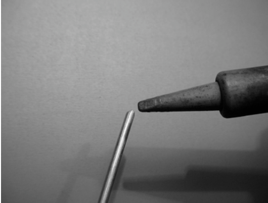
Figure 4.38: Ajouter de l'étain à l'extrémité du fil avant de souder.
