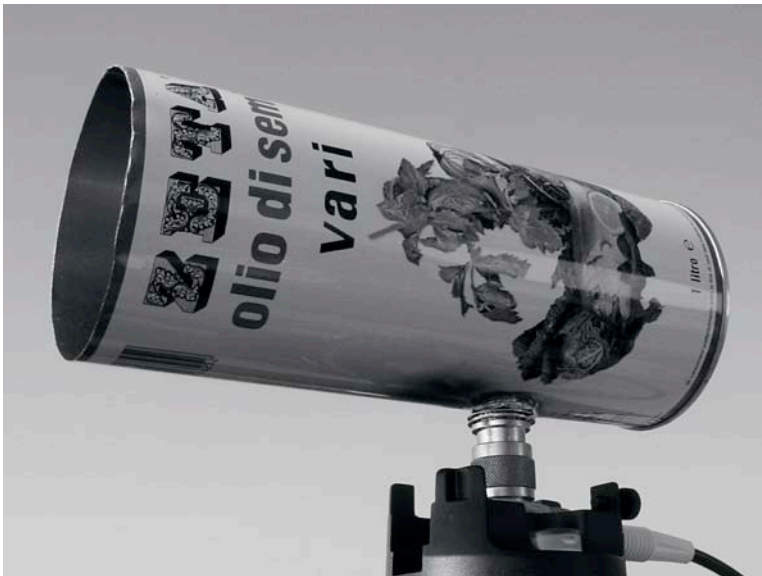
Figure 4.33: Une cantenna finalisée.
