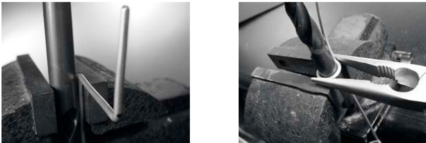
Figure 4.18: Courber le fil autour de la perceuse pour faire une boucle.
